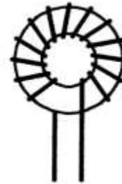
SPREAD THE TURNS EVENLY ON THE TOROIDS LEAVING A GAP BETWEEN START AND FINISH
